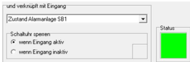
Dies erlaubt das Sperren von Türgruppen in Abhängigkeit von Fremdsystemen, wie z.B. dem Ist-Scharf Zustand einer Alarmanlage.
