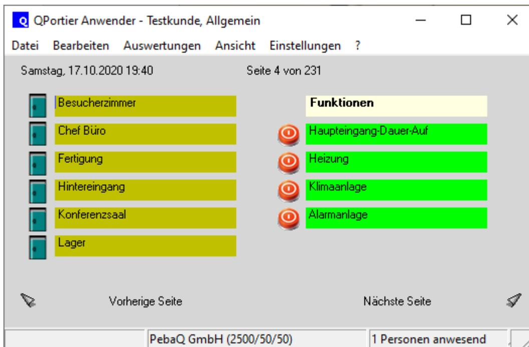
Der der Anzeige von Personen oder Gruppen, lassen sich auf den Feldern direkte Schaltfunktionen, also das Bedienen von Türöffnern oder das Schalten von gebäudetechnischen Einrichtungen hinterlegen.
